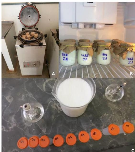
**FIGURA 2** - Esterilização dos frascos para estocagem do leite (A), leite de cabra estocado sob refrigeração em estufa incubadora tipo BOD (B) e envase do leite de cabra em frascos com Bronopol<sup>®</sup> (C).
